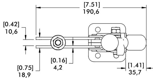
MIT ZUSATZVERRIEGELUNG DESTACO®
