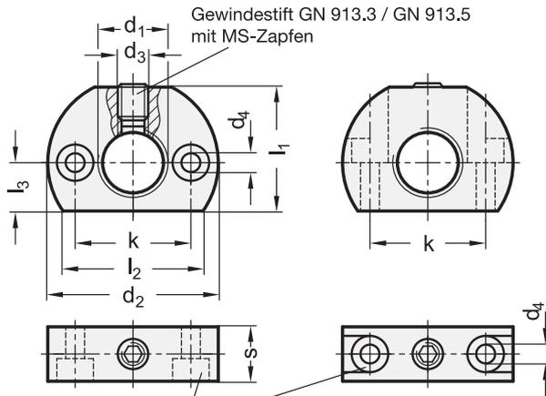
Bohrung für Zylinderschrauben DIN 912-M4/M5
