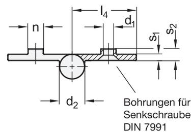
Bohrungen für Senkschraube DIN 7991
