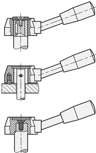
Schalthebel GN 512 befestigt mit Nabennut / Passfeder, unter Verwendung von Vorlegescheibe GN 184 → Seite 978.
