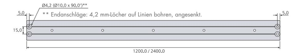
\*\* Endanschläge: 4,2 mm-Löcher auf Linien bohren, angesenkt.
